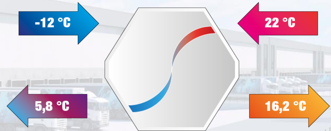
Afbeelding: werking warmte-terugwin-systeem
